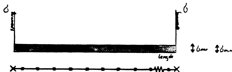
Figur 2.21 Spenningsdiagram ved fri ekspansjon og benyttelse av kompensator eller lyre
