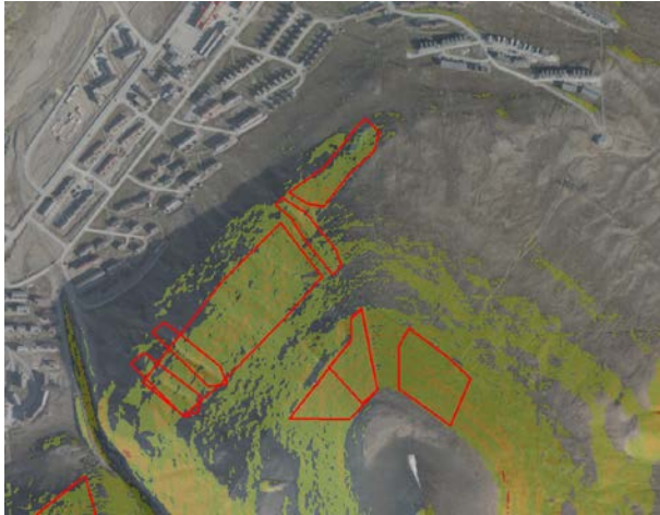
Figur 11: Løsneområder og bratthet opp mot Sukkertoppen. Brattheten vises i farger, grønn:28-35 grader, gul:35-45 grader, rød: 45-55 grader.
