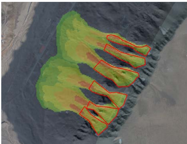
Figur 8: Løsneområder ovenfor Nybyen og modellering av snøskred med 0,5 meter snødybde i RAMMS, størrelse S, returperiode 10 år.
