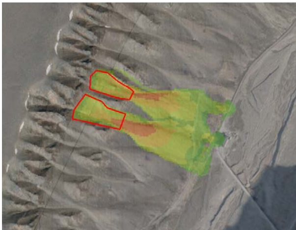
Figur 4: Løsneområder ovenfor Huset og modellering av snøskred med 0,5 meter snødybde i RAMMS, størrelse S, returperiode 10 år.
