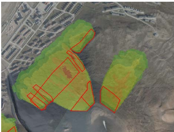
Figur 12: Løsneområder opp mot Sukkertoppen og modellering av snøskred med 0,5 meter snødybde i RAMMS, størrelse S, returperiode 10 år.
