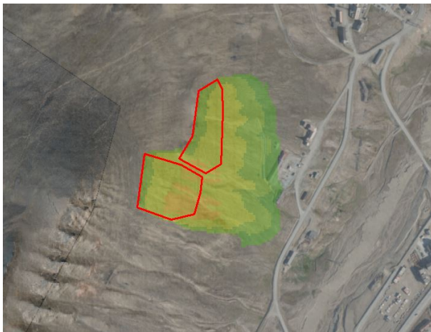
Figur 2: Løsneområder ovenfor Skjæringa og modellering av snøskred med 0,5 meter snødybde i RAMMS, størrelse S, returperiode 10 år.
