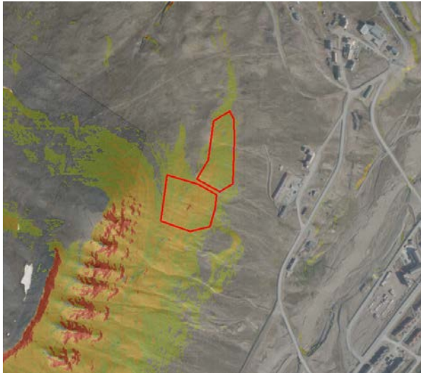
Figur 1: Løsneområder og bratthet ovenfor Skjæringa. Brattheten vises i farger, grønn:28-35 grader, gul:35-45 grader, rød: 45-55 grader.
