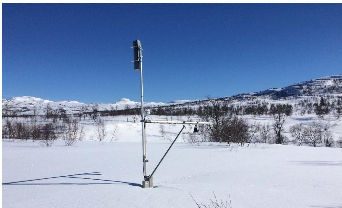
Figur 5. Snøstasjonen på 21.127 Breidvatn. Gammassensoren heng på venstre side av masta, mens snødjupsensoren heng på galgen til høgre. Bilete er tatt mot nordaust. Foto: HRB/NVE
