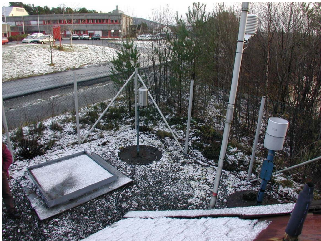
Figur 4 Urbanstasjonen 56.1 Sandsli. Her ser ein snøsmeltebrettet, to nedbørmålarar (Plumatic til høgre og Lambrecht lengst bort) og lufttemperatursensor (øvtst i biletet, på mast).
