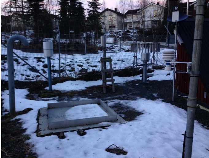
Figur 30 Utsida av Risvollan urbanstasjon med temperatursensor, snøsmeltebrett og 3 nedbørmålarar (Plumatic t.v., Lambrecht i midten og Geonor t.h.).
