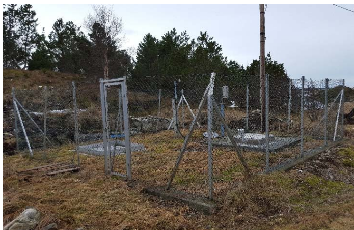
Figur 26 Nedbørmåler, snøsmeltebrett og temperatursensor er lokalisert innanfor eit gjerde
