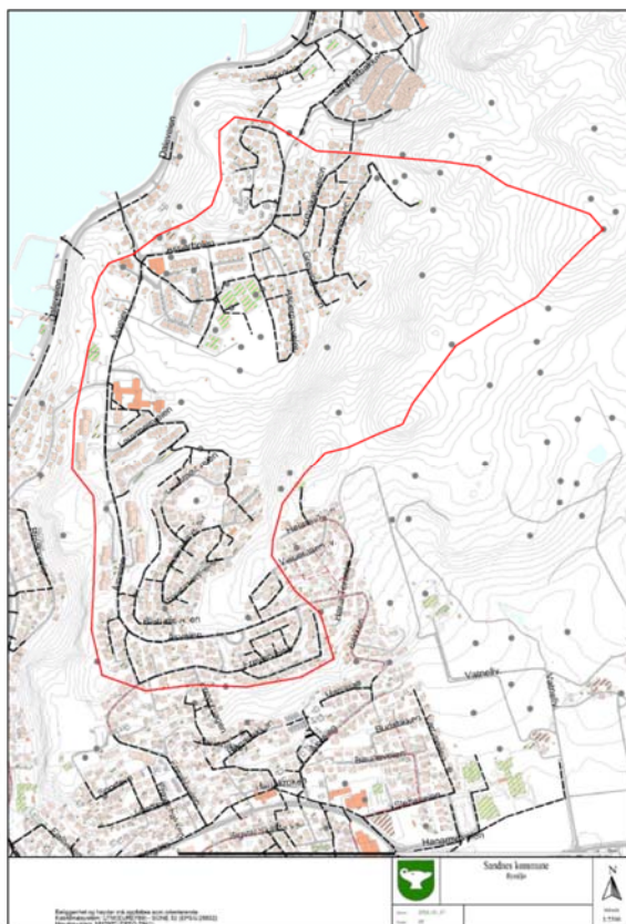
Figur 20 Kart med nedbørfelt og overvassnett på Aspervik. Kjelde: Sandnes kommune.
