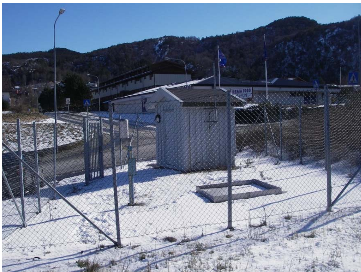
Figur 19 Stasjonen på Aspervik. Snøsmeltebrett i forgrunnen.
