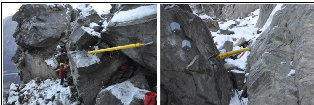
Figur 17: Ekstensometra er monterte frå fjellveggen til blokker og vidare mellom blokkene i det ustabile området. Ekstensometra er nummererte 8, 9 og 10, frå høgre til venstre.
