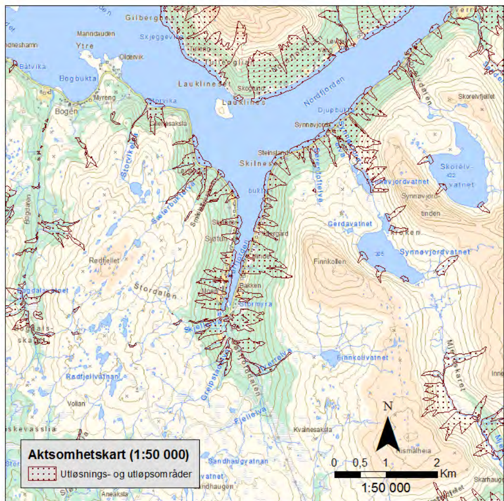
Figur 24b: Detalj av kart i figur 24a. Kart viser hvor jordskred og små flomskred kan forventes i dette området. Brune områder er resultater av modeller og viser hvor kan skred starte og hvor kan avsette seg. (utløsningsområder og utløpsområder er ikke differensiert fra hverandre). Grenser av områder er avhenging av parameterne og målestokk brukt i modellen (fra www.skrednett.no , og skredatlas.nve.no ).
