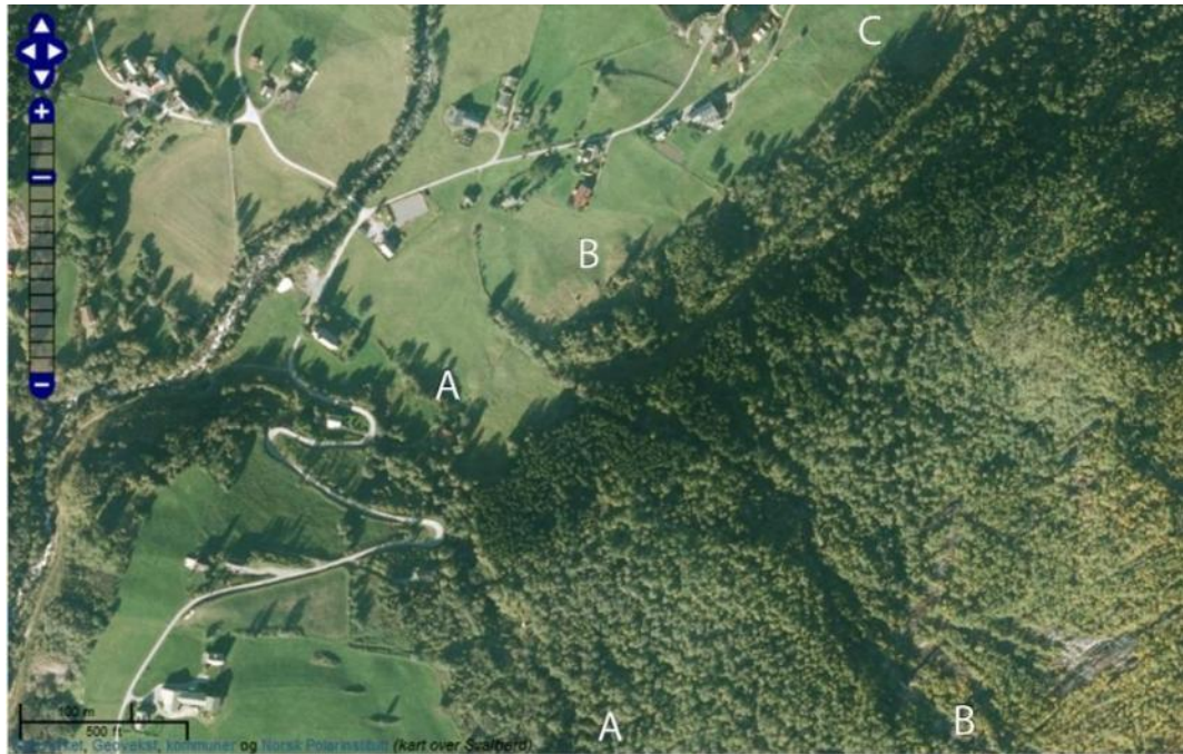
Fig. 9.5.1.4. Skredbaner i østre dalside i Ortnevika, A-A og B-B. A-B-C på dyrkamarka viser skredavsetninger med enkelte skredspor. (Norgebilder.no).
