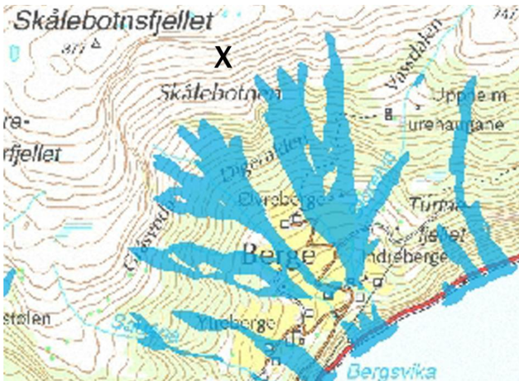
Fig. 5.2.2. Jordskredmodellering ved Berge utført av NGU. X markerer ca. løснеområde for Bergeskredet 26.12.2011.
