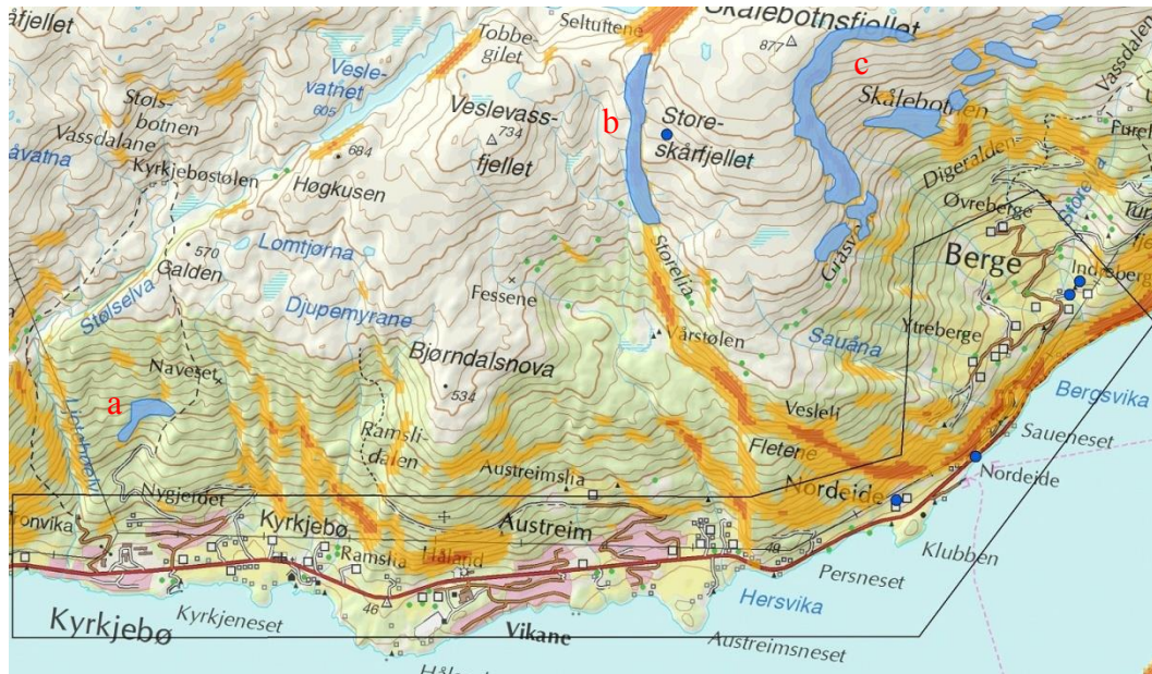
Fig. 5.3.1.1. Helningskart over område 2 (lysere oransje viser terreng 30-40°; mørkere oransje viser terreng 40-60°). Kartet viser også de vurderte løснеområdene (blå områder) og tidligere snøskred fra den nasjonale skred databasen (blå prikker).
