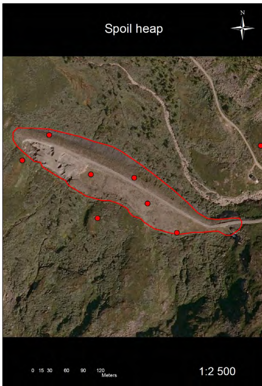
Figur 3. Steintippen i Øydalen, Lærdal kommune, med lokalisering av fem blokker på selve tippen og tre blokker i omgivelsene, vist som røde prikker. I hver blokk ble tre ruter á 0,5 m × 0,5 m plassert tilfeldig.
