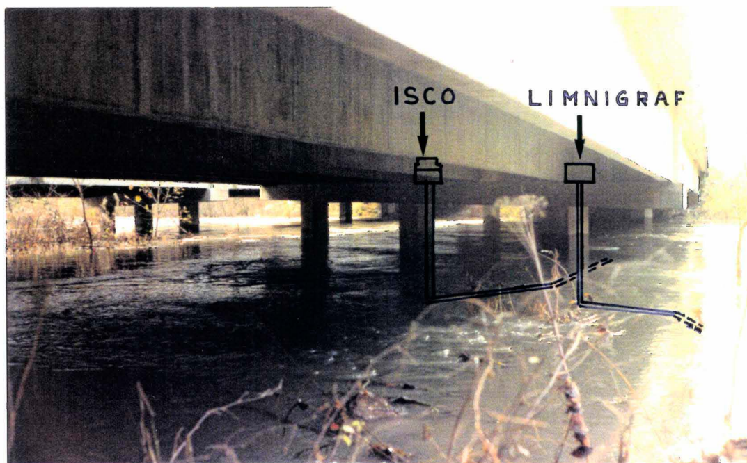
Figur 2. Kjellstad bru. Den automatiske vannprøvetakeren ISCO og limnigraf, med trykksensor, er inntegnet. Bildet er tatt under flommen 30. oktober 1990.
