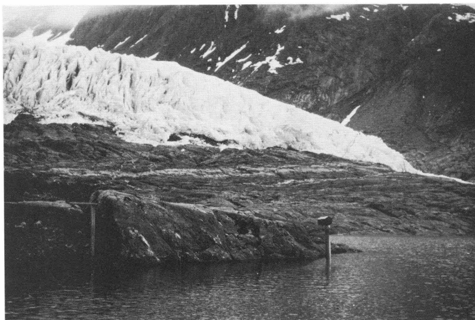
Fig. 7 Vannmerke (til venstre) og limnigraf i den indre delen av Engabrevatnet. Fronten av Engabreen i bakgrunnen.
