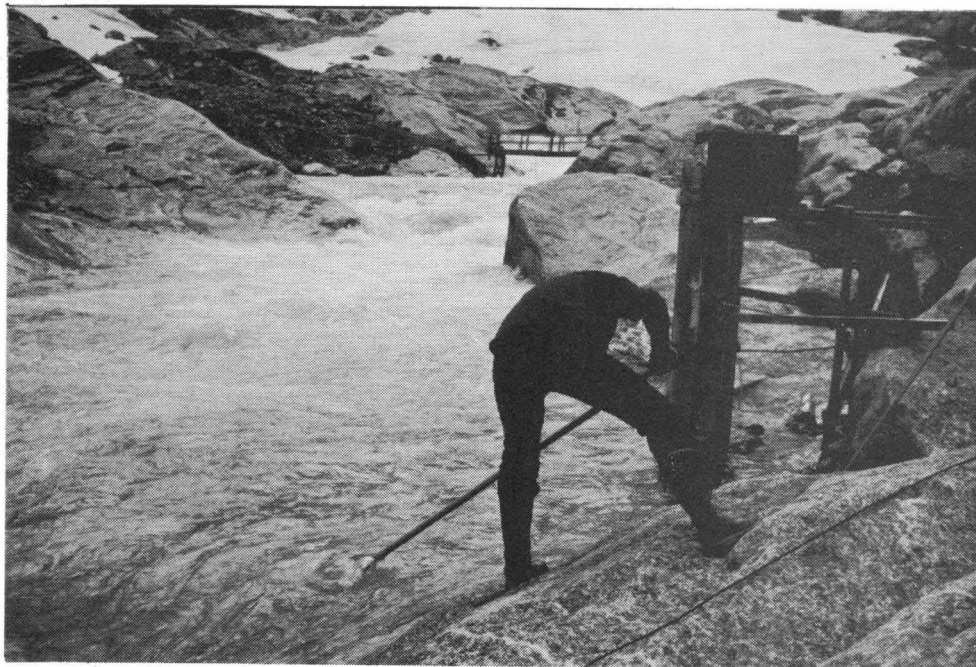
Fig. 2 Vannprøvetaking for analyse av innholdet av suspendert materiale. En 1-liters plastflaske settes i en beholder på en 2-meter lang stang og holdes på skrå opp mot strømmen nedenfor en turbulent strekning i elva. Her ved Nigardsbreen mellom breen og Nigardsvatnet. Til høyre et vannmerke og en limnigraf.
