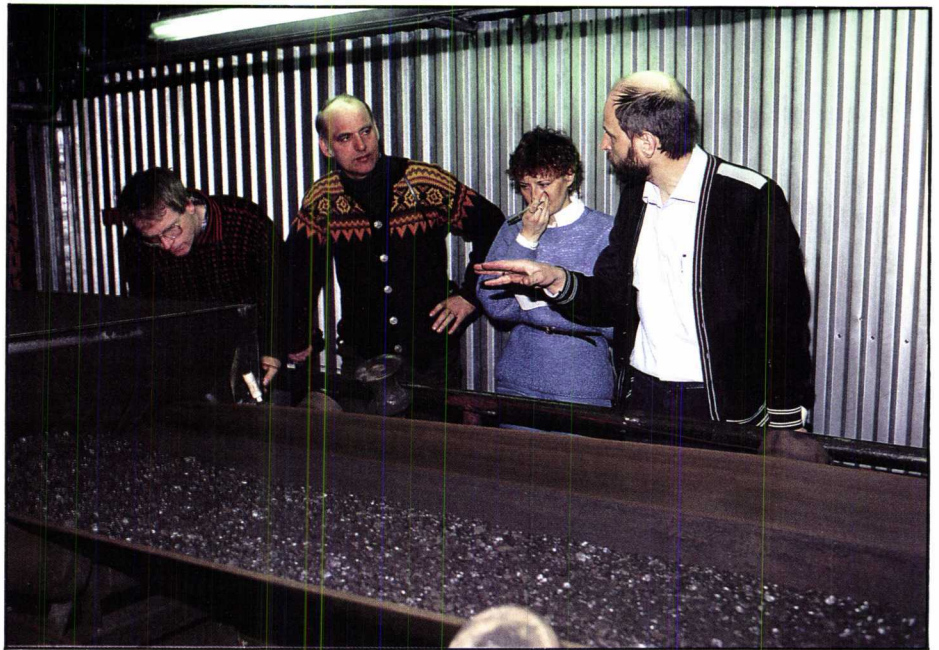
Kullet transporteres fra fyllkasse til kullsilø på et spesialkonstruert transportbåndsystem. Ved hjelp av luker i transportbåndet og undertrykk i siløene holdes støvmengdene nede i anlegget. — Dette er vårt eget patent, kan driftsleder Einar Ohm fortelle.
