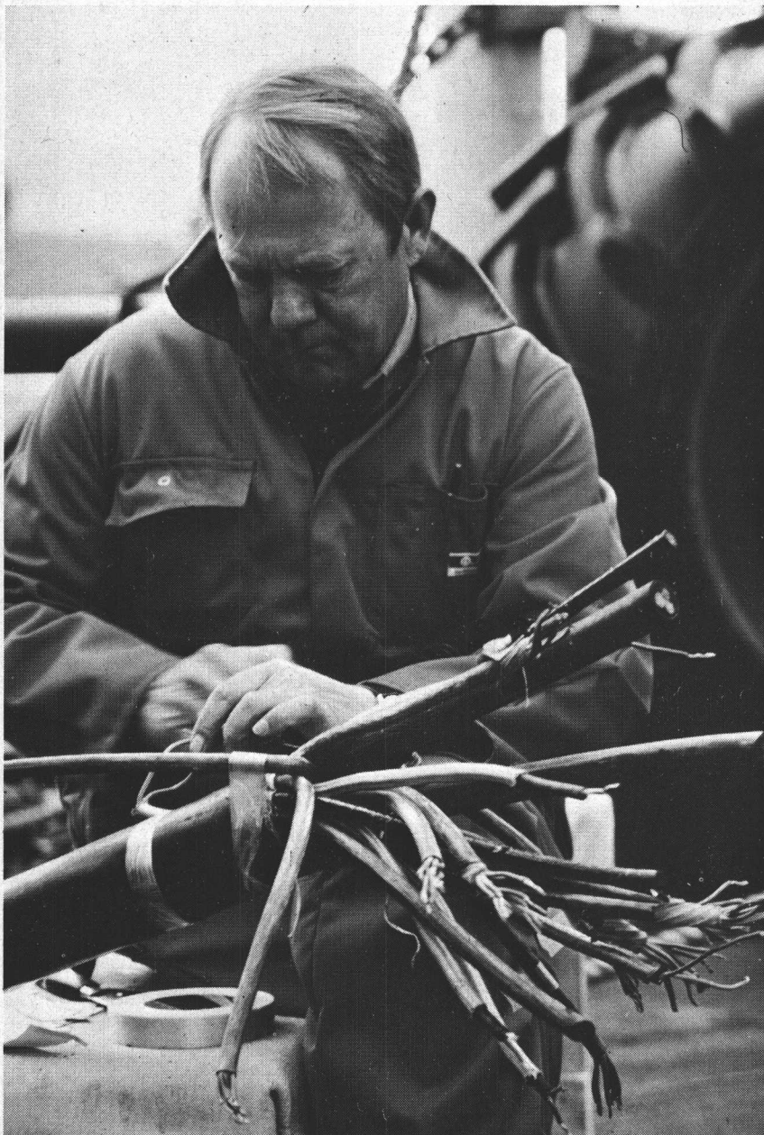
Overing. Erling Christensen, ELSAM, er hovedmannen bak konstruksjon og prosjekt. Her opptatt med sitt problembarn strømtilførsels-/signalkabelen, graveutstyrets navlestreng.
