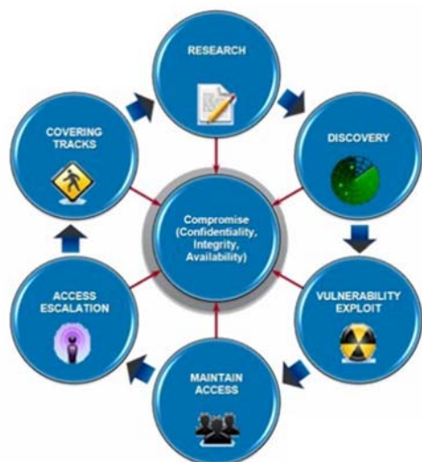
Figur 1: Etterretning for cyberangrep er en kontinuerlig prosess. Angrepsmetoden er hentet fra ICS-Cert. USA. leverandører, underleverandører og andre slik som media, myndigheter, akademia m.fl. Trusselaktører kan kontinuerlig overvåke nettsider som arkiverer kjente sårbarheter med systemer, og vente på at «riktig»
