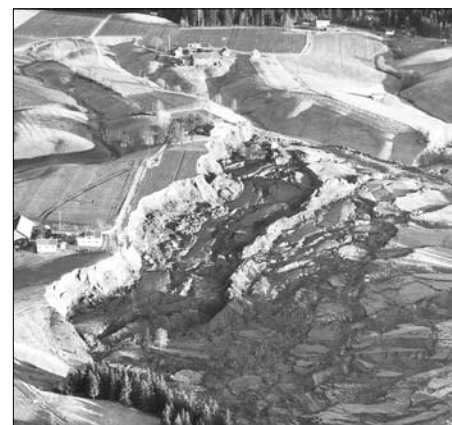
Bildet viser kvikkleireskredet ved Båstad ved Øyeren i 1974. Terrenget er et typisk ravinelandskap. I ravinene har mindre bekker erodert over lang tid. Samtidig har utfylling av ravinene ført til endret stabilitet. Skredet er monolittisk. Det betyr at hele skredområdet skle ut i en hendelse. Det var intet forsvarsel i forkant av skredet. Foto: Fjellanger-Widerøe
