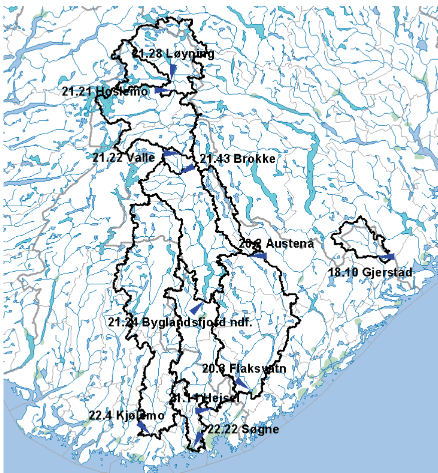
Figur 7. Oversikt over avløpsstasjoner benyttet i beregningene. Nedbørfeltet til hver enkelt stasjon er inntegnet med svart strek.
