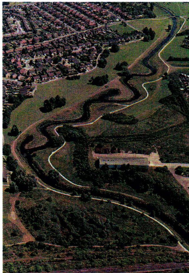
River Skerne slik prosjektet fremstår tre år etter at det ble ferdig. To km kanal er omformet til et levende elveløp med bakevjer og våtmarker. Rundt vassdragsområdet er det opparbeidet parkområder med gjennomgående turveisystem. Prosjektkostnadene kom på noe over 3 mill. kr.
